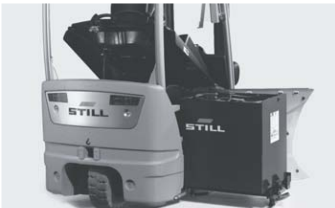
Puente de batería integrado para el cambio lateral de la batería utilizando una grúa
